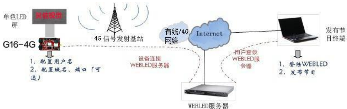
图 1-7 G16-4G 工作原理
