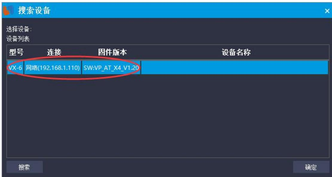
(2)使用【动态 IP】连接方式时，保证插在设备上的网线的另一端插在与电脑网络的同一个路由器上，然后选择【动态 IP】，设备会自动获取 IP 地址，若 IP 地址获取成功，打开
